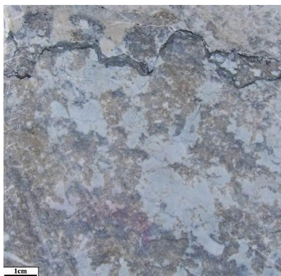
شکل ۴- حضور ترومبولیت‌ها در قاعده سازند کنگان در نمونه دستی در چاه A
