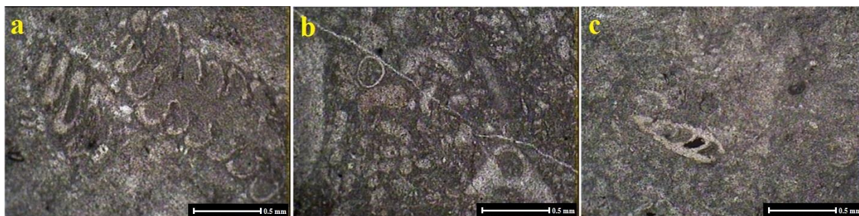
شکل ۹- رخساره‌های دریای باز؛ a. پکستون/وکستون فرامینفردار، b. بایوکلاستیک پکستون، c. بایوکلاستیک وکستون
