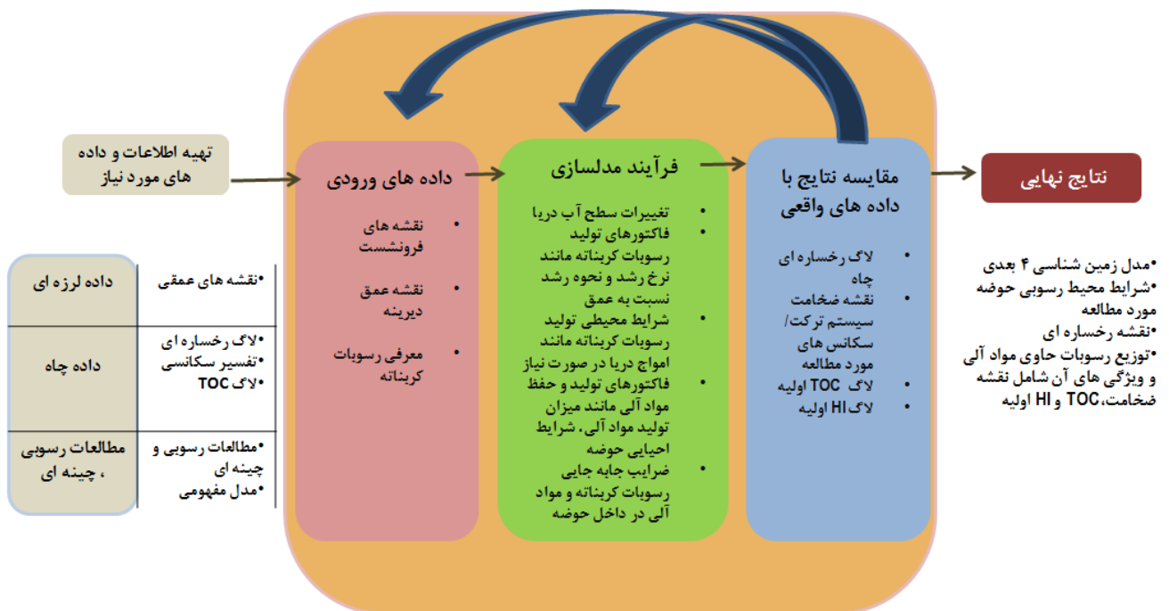
شکل ۵- نمودار گردش کار کلی ساخت مدل چینه‌ای در نرم‌افزار DionisoFlow
